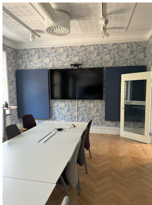
Bild till höger: Flex Bas monterad mot vägg i konferensrum. Extra tjocka absorber som även dämpar ljud i de lägre frekvenserna och därmed bidrar till bättre taluppfattbarhet som är extra viktigt i ett konferensrum.
